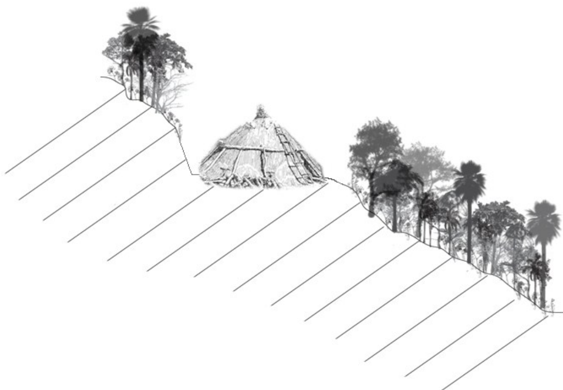
Figura 2: Esquema de uma carvoaria, evidenciando o corte do talude.
