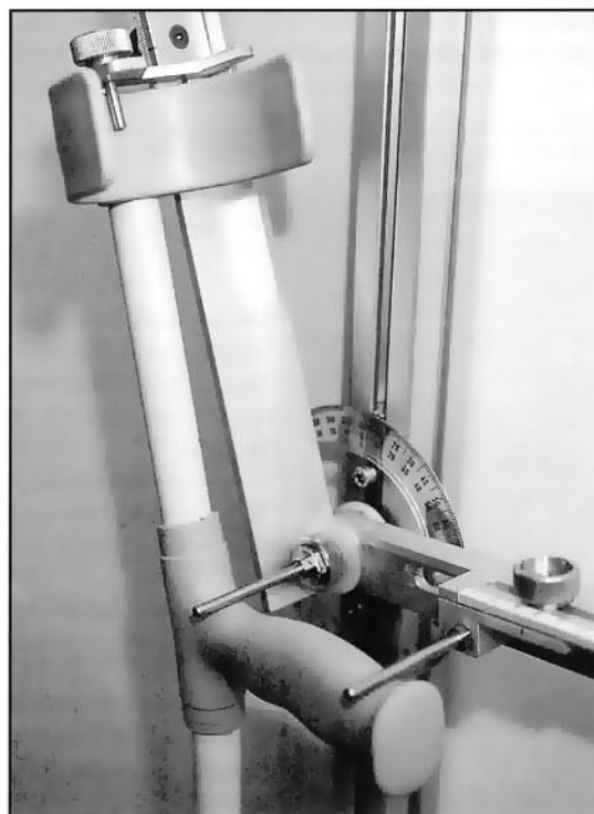
Dispositivo normalizado de caracterización dimensional de las muletas
