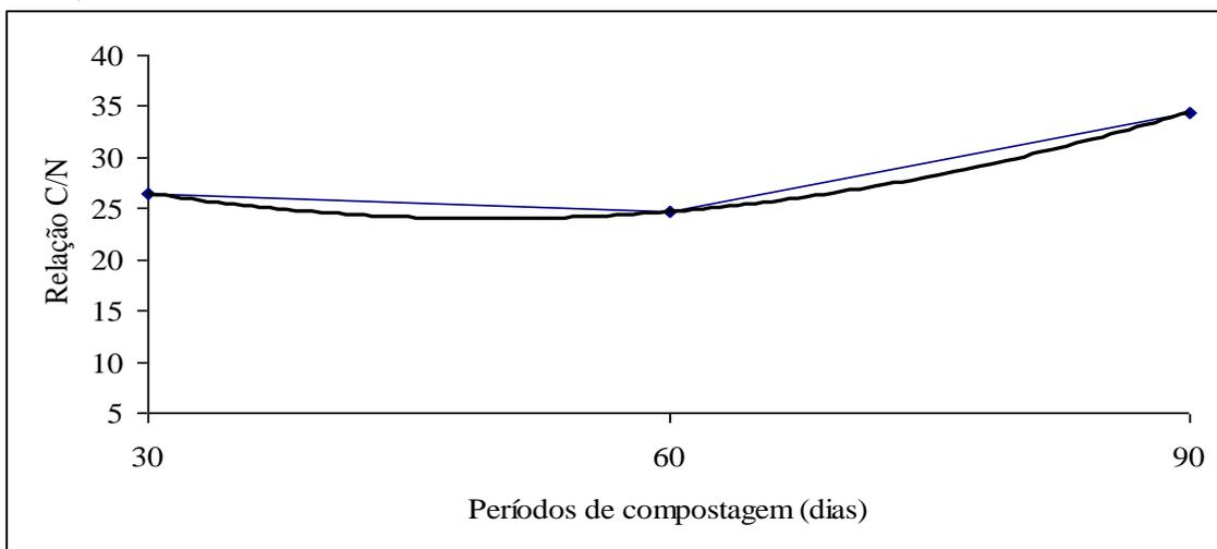
**Figura 4.** Comportamento do teor de nitrogênio total (N) e relação carbono/nitrogênio (C/N) durante a compostagem da mistura de cama aviária e resíduos sólidos da coturnicultura (excretas + ração + ovos descartados para consumo). N:  $y = 1,056 + 0,0338x - 0,0003x^2$  ( $R^2 = 1$ ); Relação C/N:  $y = 39,942 - 0,6425x + 0,0065x^2$  ( $R^2 = 1$ ).
