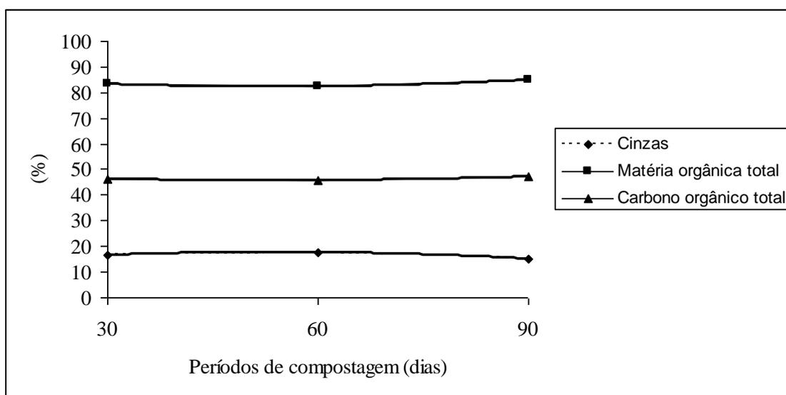
**Figura 3.** Comportamento dos teores de cinzas (CZ), matéria orgânica total (MO) e carbono orgânico total (C) durante a compostagem da mistura de cama aviária e resíduos sólidos da coturnicultura (excretas + ração + ovos descartados para consumo). CZ:  $y = 11,798 + 0,2196x - 0,002x^2$  ( $R^2 = 1$ ); MO:  $y = 87,8 - 0,2084x + 0,002x^2$  ( $R^2 = 1$ ); C:  $y = 48,778 - 0,1158x + 0,0011x^2$  ( $R^2 = 1$ ).
