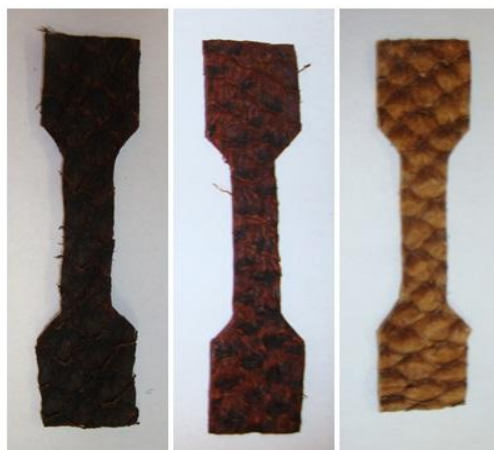
Figura 6 – Corpos de prova dos couros curtidos a partir de casca de cajueiro, casca de aroeira e casca e gume de banana verde, respectivamente.
