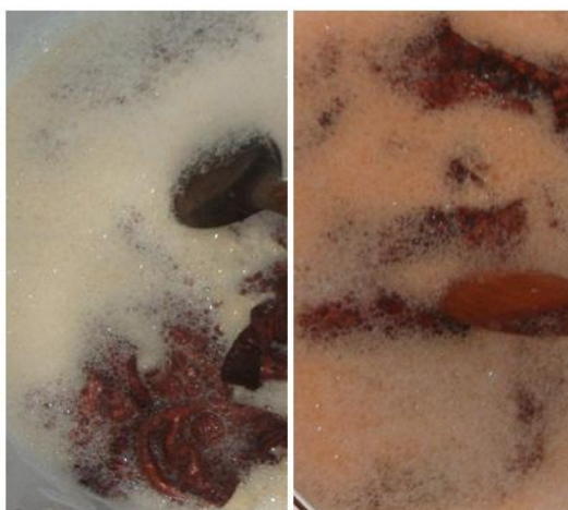
Figura 3 – Engraxe dos couros de tilápia ( Oreochromis sp.) curtidas com casca de cajueiro ( Anacardium sp.) e casca de aroeira ( Schinus sp.), respectivamente.
