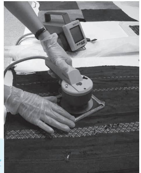
FIGURA 3. Medición de Color con espectrofotómetro.
