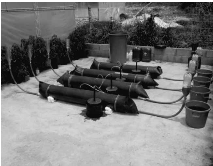
Figura 4: Pruebas experimentales para medir y comparar alternativas de biofiltros propuestos. Fuente: Limongi (2003:112)
