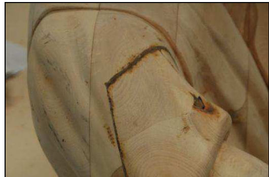
8. Proceso de mecanizado por robot: programación de trayectorias, simulación y fresado.
