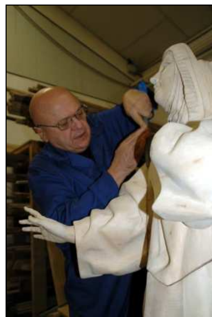
9. Unión de las partes mecanizadas; perfiladas y repasadas por escultor.
