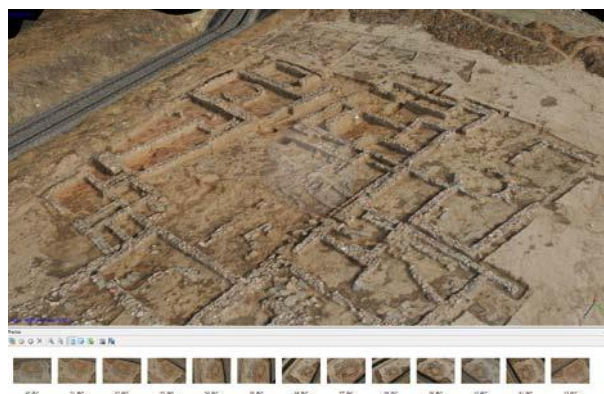
Figura 5: Modelo generado a partir de 16 fotografías aéreas en Agisoft PhotoScan.
