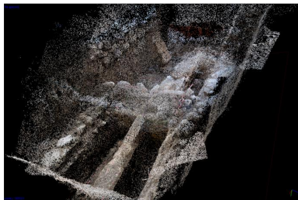
Figura 8: Nube de puntos de los enterramientos de Tortosa generada con software SFM.
