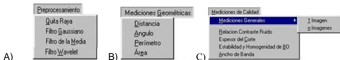
Figura 5. A) Menú preprocesamiento. Filtros disponibles para el usuario (es indistinto si son realizados en el dominio del espacio o de las frecuencias espaciales). B) Menú de mediciones geométricas. C) Módulo de Mediciones de calidad, donde están las pruebas de Relación Señal Ruido y No Uniformidad para una o varias imágenes.
