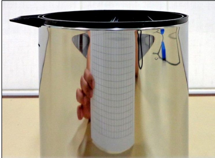
Fig. 4 – Imagem deformada em um espelho cilíndrico convexo devido à curvatura de campo.
