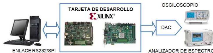
Fig. 19: Esquema de medición empleado para la verificación funcional.
