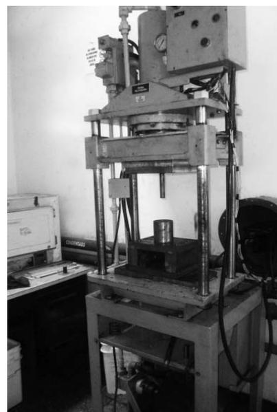
**Figura 2.** Prensa Pelletizadora
