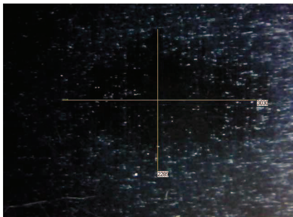
Fig. 3. Medición de la huella de desgaste del recubrimiento DLC/Si mediante microscopia óptica.
