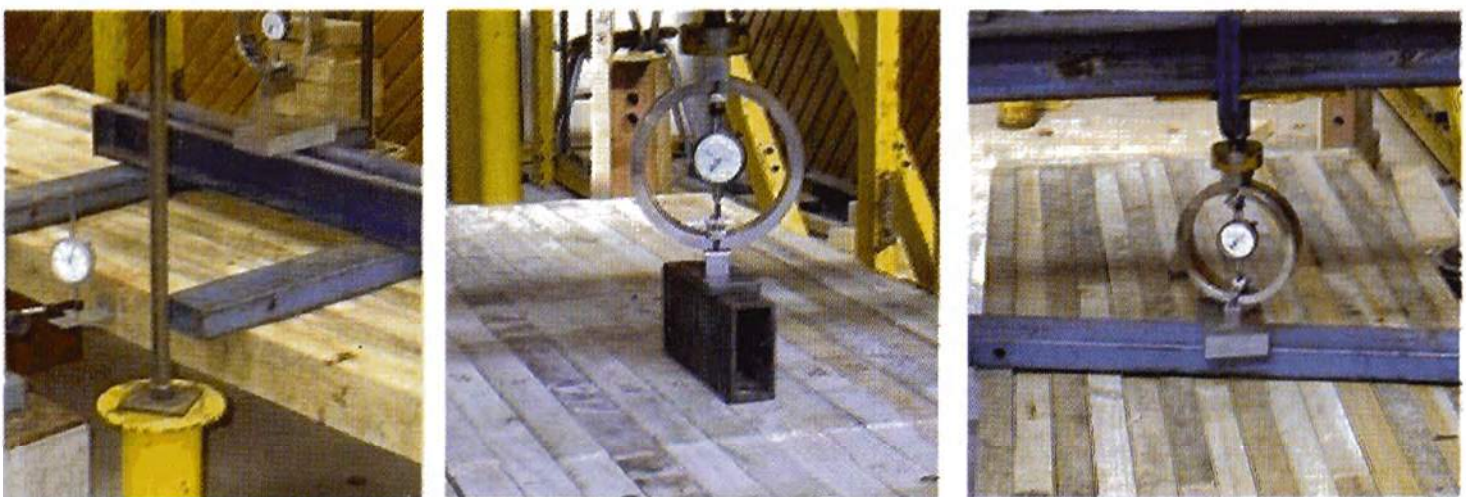
Figura 5: Fotos de los ensayos de flexión. Ensayos de paneles a cargas horizontales
