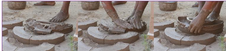
Fig. 4. Conformado de un ladrillo curvo. Matilde Navarro, 2013
