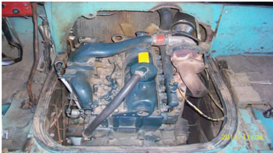
Esta diferencia en el índice de consumo entre vehículos con motores de gasolina y motores de diesel es la que justifica la remotorización como medida de ahorro; ya que por cada litro de diesel consumido se ahorra uno de gasolina para trasladarse la misma distancia; pues con un motor de gasolina un bus de este tipo necesita dos litros para desplazarse cinco kilómetros, mientras que con un motor de diesel, lo hace solo con un litro.
