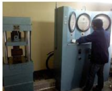
Figura 2. Ensayos de resistencia a la compresión paralela a la fibra
