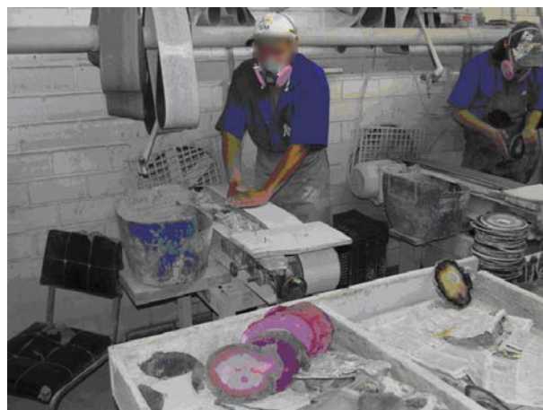
Figura 9: Imagem de equipamentos para lixar e polir chapas de ágata, setor de acabamento [Fotografia de Álvaro Scur].
