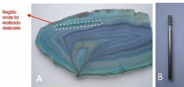
Figura 17: Ensaio de usinagem convencional. Em A) Chapa de ágata com espessura de 3,0 mm, mostrando a trajetória do desbaste (pontilhado) e em B) ferramenta diamantada.
