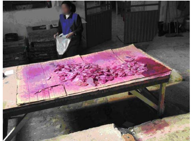
Figura 13: Chapas tingidas – etapa de secagem [Fotografia de Álvaro Scur].
