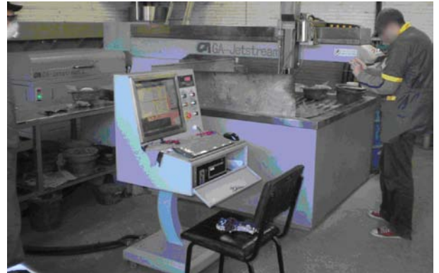
Figura 16: Equipamento para usinagem por jato d'água CNC da marca Jetstream.
