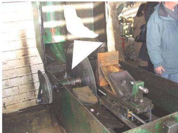
Figura 8: Imagem de equipamento para corte de geodos de ágata em chapas [Fotografia de Álvaro Scur].
