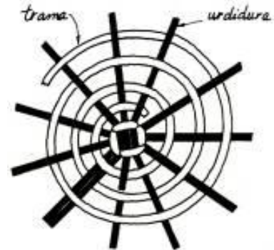
Figura 12: Trançado de cesto. Hastas de fibra dura, que formam a urdidura, sustentam a trama espiralada flexível. Fonte: Doczi, 1990
