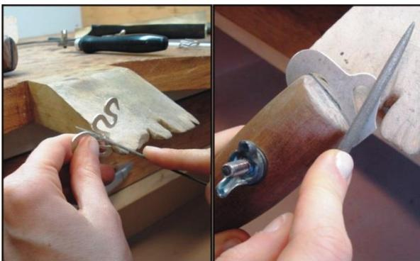
Figura 17: Modelo serrado recebendo acabamento primário com a lima.
