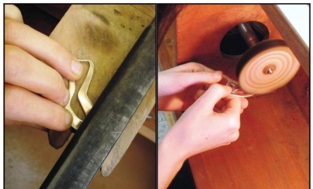
Figura 19: Acabamento final, lixa para tirar riscos da lima e polimento em máquina politriz.
