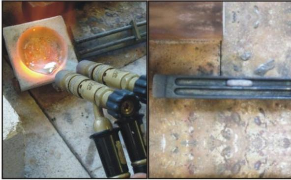
Figura 131: Fundição da prata com maçarico em um cadinho refratário e a prata derramada em forma de lingote.
