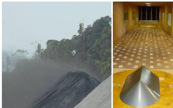
Figura 24: Emissão de material particulado no topo de uma pilha de carvão e modelo reduzido da pilha no interior do túnel de vento (Loredo-Souza et al., 2005b).
