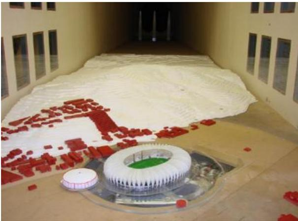
Figura 20: Fotografias do modelo reduzido da nova cobertura do *Estádio Beira-Rio* no interior do túnel de vento em escala 1:500. (Loredou-Souza et al., 2010).
