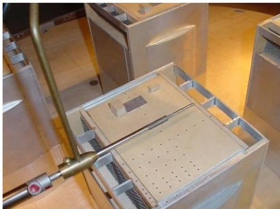
Figura 25: Esquema da separação do escoamento no topo de edificações com arestas vivas e modelo no interior do túnel de vento (LOREDO-SOUZA et al., 2002).
