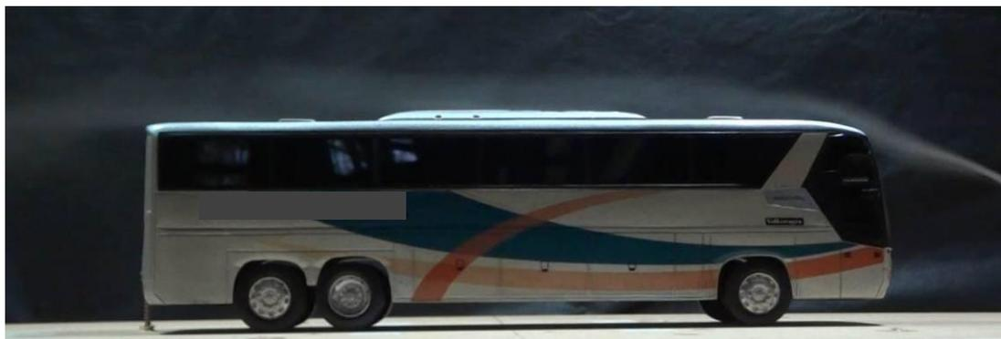
Figura 30: Fotografia da visualização do escoamento com injeção de fumaça em torno de um modelo reduzido de um ônibus (vento incidindo na horizontal, da direita para a esquerda).
