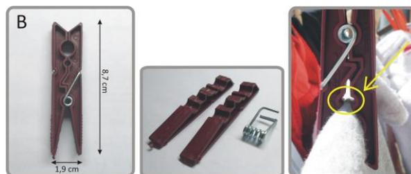
Figura 21: Análise estrutural da amostra B, com dimensões, desmonte e em uso.
