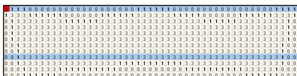
Figura 1: Molde representado pelo método raster .
