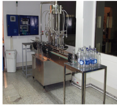
Figura 1. Embotelladora de planta de procesos del laboratorio de automatización industrial de la Facultad de Ingeniería de la FUAC.
