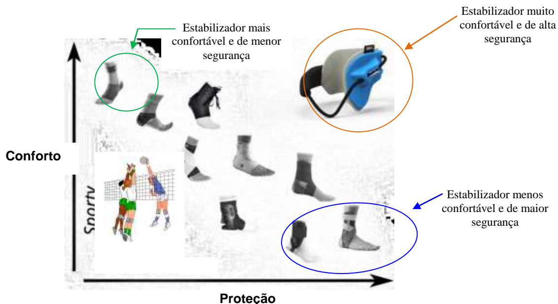
Figura 3 - Relação entre grau de proteção e conforto para a prática esportiva do estabilizador.
