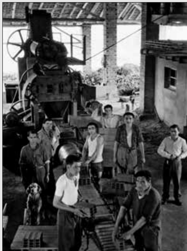
VARIOS OPERARIOS TRABAJANDO EN LA EXTRUSORA HACIENDO LADRILLO HUECO. FOTO JOSÉ M a GONZÁLEZ VILLANUEVA
