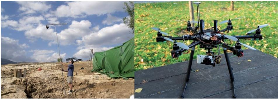
Fig. 9. Monopode extensible para la fotografía terrestre y hexacóptero profesional para la foto aérea.
