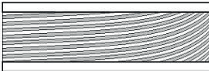
Sección de ánima rayada con ganancia de torsión.
