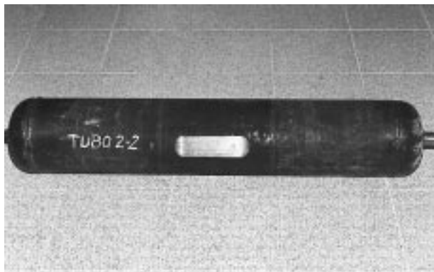
Figura 1. Fotografía del tipo de probetas utilizadas para las pruebas de ruptura hidrostática. En el centro se observa la reducción en el espesor realizada por mecanizado.
