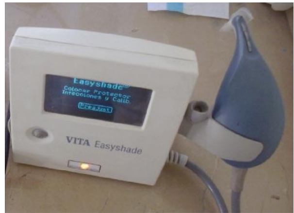
Figura 4. Espectrofotómetro Easy Shade.
