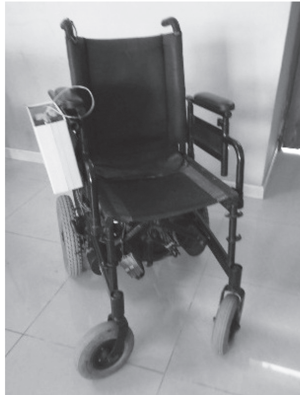
Figura 6. Foto de Silla de Ruedas Desarrollada. El movimiento de la silla es controlado por la mente a través de neurotecnología y la interfaz electrónica basada en la Plataforma Arduino.
