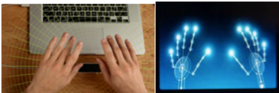
Imagen 2 Leap Motion, permite interactuar con la mayoría del software en el mercado, reemplazando al mouse y teclado, utilizando solo el movimiento de las manos. Fuente: www.leapmotion.com/product
