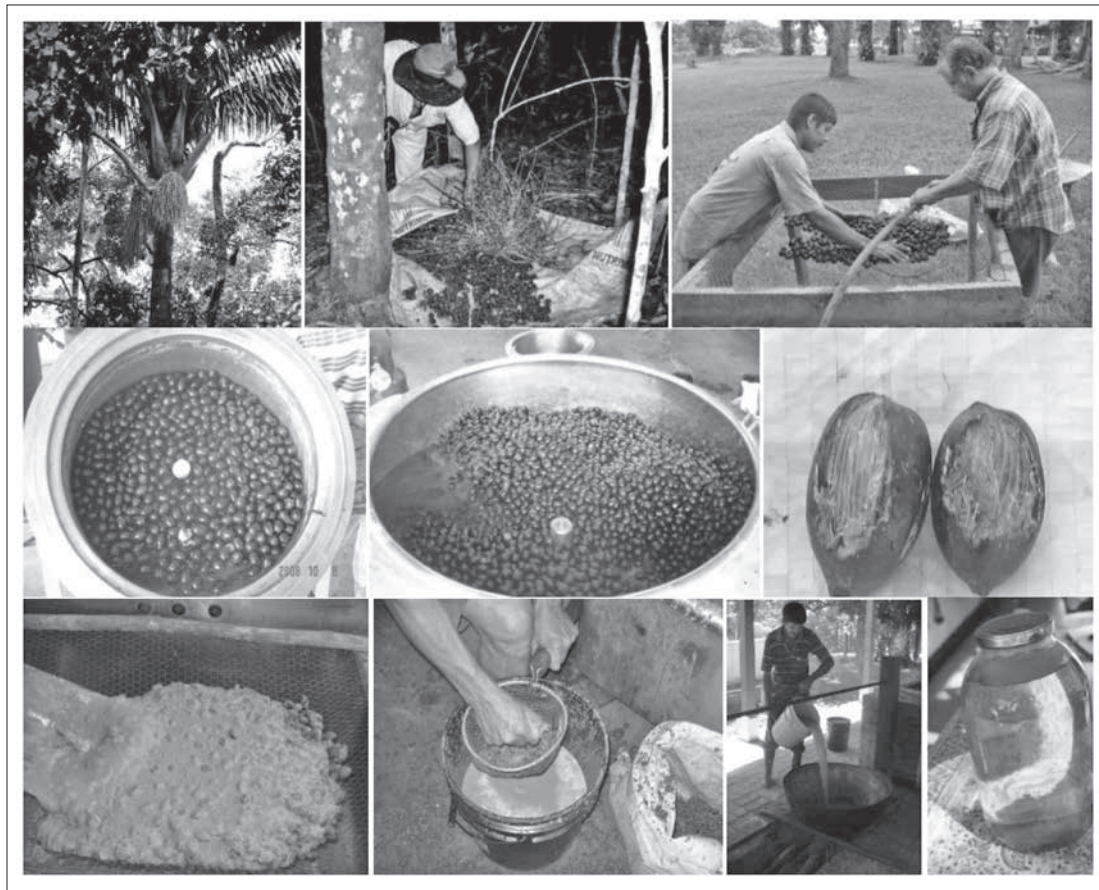
Figura 4. Proceso de extracción de aceite de seje (primera línea, cosecha y lavado de fruta de seje; segunda línea, cocción de la fruta y fruta en proceso de despulpado; tercera línea, salida de fruta del despulpado, separación del “unche”, proceso de separación por calor y aceite de seje).
