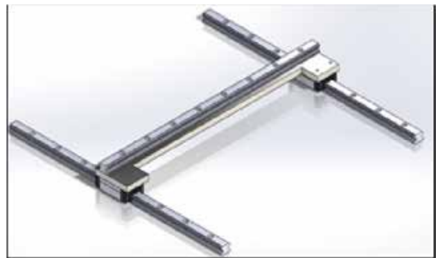
Figura 18. Conjunto placa-bancada-guías lineales y longitudinales
