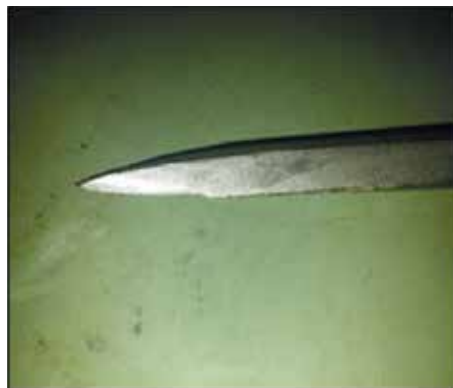
Figura 11. Cuchilla de torno
