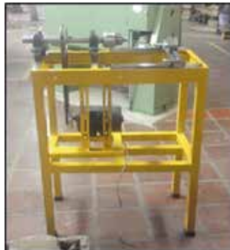
Figura 28. Torno para el mecanizado de caucho construido
