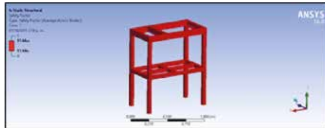
Figura 27. Factor de seguridad para la estructura
