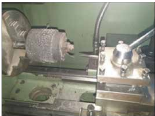
Figura 10. Práctica de corte de goma dura para medir la potencia activa
