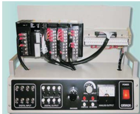
Fig. 2. Autómata programable OMRON ® : Fuente, CPU y módulos de izquierda a derecha.
