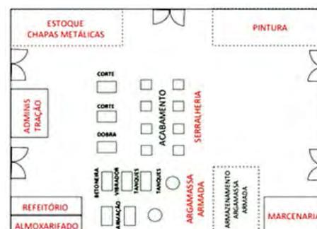
Figura 7. Layout esquemático da Fábrica de Equipamentos Sociais de Ribeirão Preto
