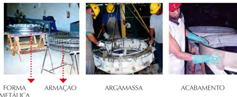
Figura 8. Processo produtivo anel de caixa d'água
