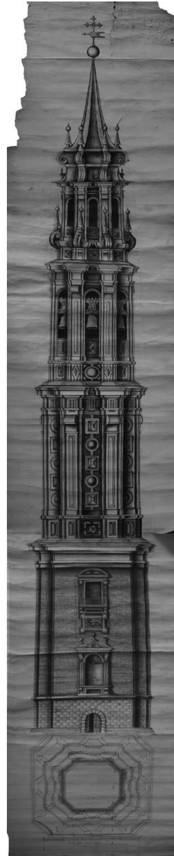
Fig. 4. Gaspar Serrano, prospetto e pianta del campanile della cattedrale di Saragozza, 1683 (ACLSZ, Trazas y dibujos, n. 110).
