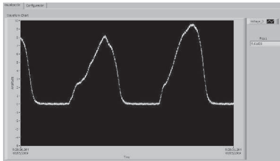
Fig.11. Gráfico de fuerza obtenido con el prototipo de palanca.
