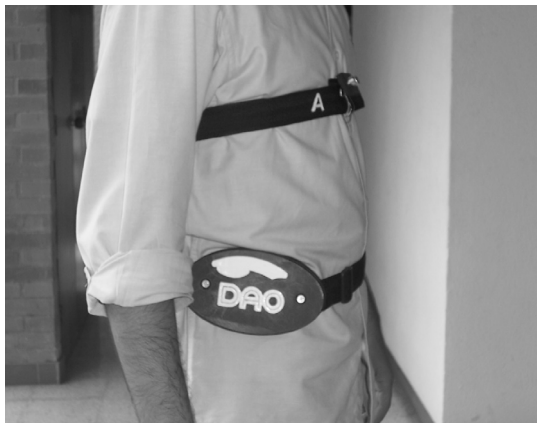
Fig. 4. En la parte inferior de la fotografía se puede ver la carcasa del circuito y en la parte superior se pueden observar los transductores ultrasónicos (emisor y receptor).
