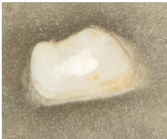
**Figura No 1.** Fragmento de 5x5 mm en troquel acrílico.
