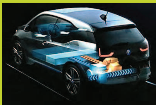
Funcionamiento del vehículo en modo autonomía extendida (REX): el grupo electrógeno auxiliar de gasolina de 34 CV (en naranja) alimenta las baterías y éstas el motor eléctrico y las ruedas
