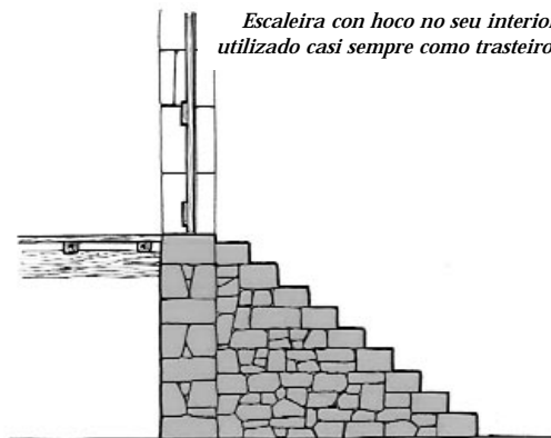
Escaleira maciza sin aproveitamento interior.
