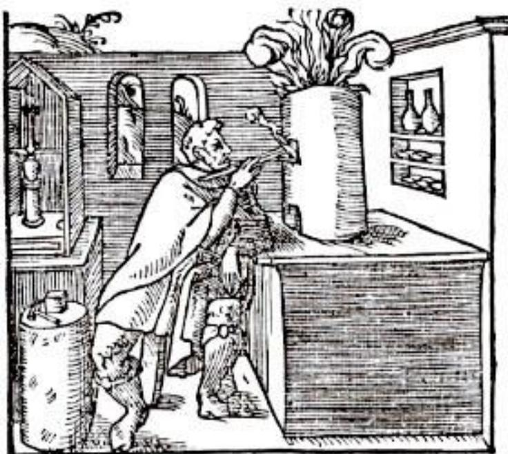
Grabado procedente de la obra de Juan de Arfe, *Quilatador de plata, oro y piedras* (1572). En ella se puede observar la presencia de una balanza (parte superior izquierda) y al propio Arfe introduciendo una copela en el horno durante una operación de ensayo.
