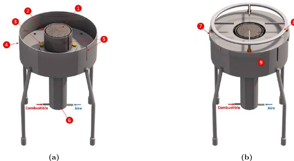
Figura 1. Quemador experimental para la evaluación de las superficies porosas seleccionadas. a. Configuración sin cubierta. b. Configuración para la medición de eficiencia y emisiones contaminantes.
