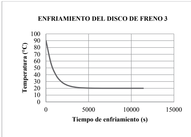
Figura 6. Gráfica del enfriamiento de Newton para el disco de freno 3, a temperatura ambiente. Fuente: El Autor.
