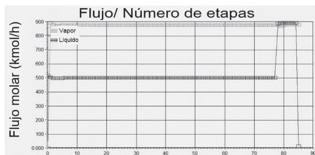
Figura 5. Perfil de flujos molares de líquido y vapor en la columna destiladora en la pervaporación.
