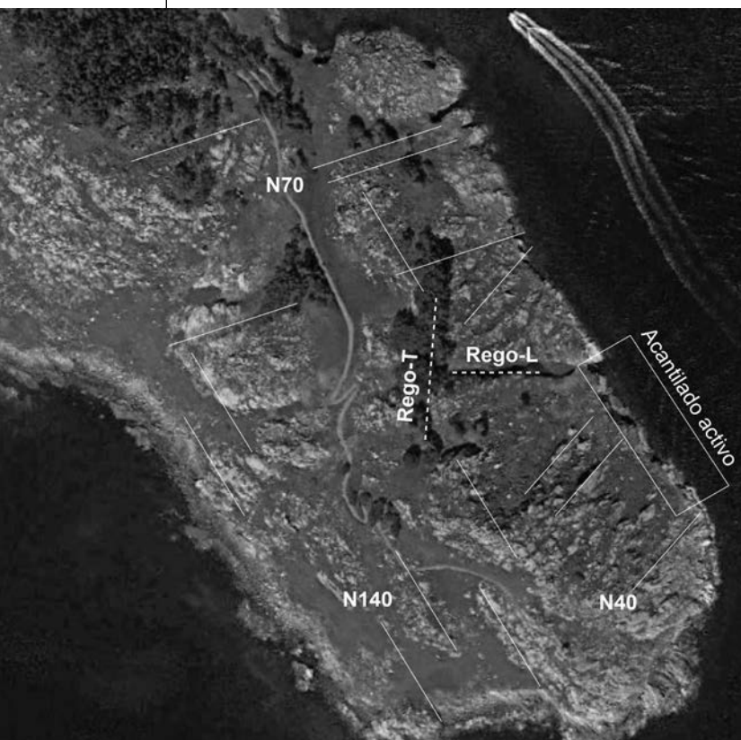
Figura 2. Imagen de Google Earth de la isla de San Martiño sobre la que se señala la posición de las tomografías (en línea discontinua); las direcciones estructurales principales N40, N70 y N140 que configuran los principales rasgos del relieve; y la situación del acantilado activo.
