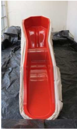
Figura 6b. Molde desarrollado por la escudería ARA para la fabricación de la carrocería a) macho, prototipo a escala real y b) hembra, molde para laminado. Imágenes propias.
