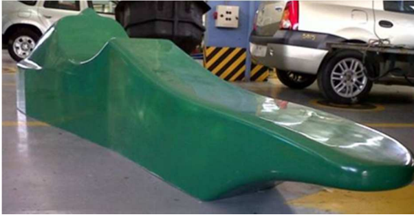
Figura 5a. Molde desarrollado por la escudería ARA para la fabricación de la carrocería a) macho, prototipo a escala real y b) hembra, molde para laminado. Imágenes propias.
