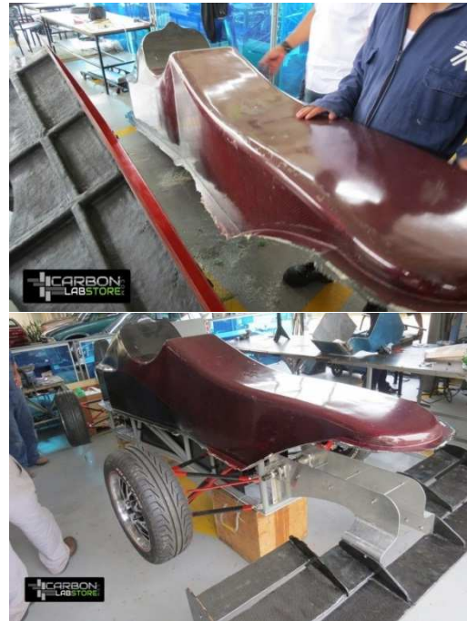
Figura 9. Carrocería final del monoplaza de la escudería ARA. Imágenes suministradas por CarbonLabStore®
