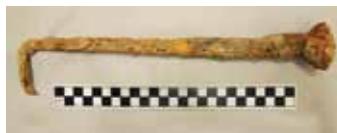
Figura 2*. Clavo con cabeza convexa maciza de sección circular; cuerpo de sección cuadrada. Unión de maderos, vigas y columnas (pilares). Estructural. Cat. 541-2013
