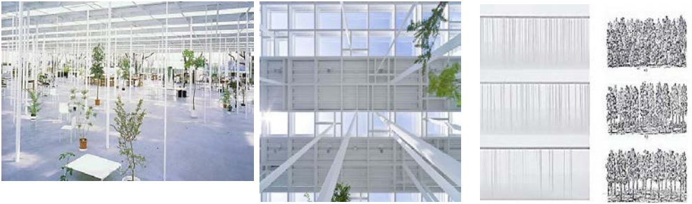
Figura 8. Junya Ishigami. KAIT Workshop. Vista del espacio interior y de la cubierta Figura 9. Ídem. Estudio de densidad de soportes y comparación con la densidad de árboles de un bosque 16
